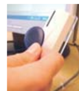
USB-RIF – Pöytälukijalla varustettu lukijarajapintamuunnin korttien ja tunnisteiden ohjelmointiin, tunnisteiden nopeaan hakuun ja järjestelmään kirjautumiseen.
